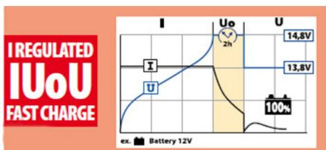
Sa courbe de charge offre une charge ultra-rapide (ex : 5h au lieu de 8h), avec tous les avantages d'une charge automatique à 100%
